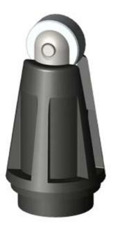
ACTUATOR HEAD FOR POSITION SWITCH 3SE51/52 ROLLER PLUNGER, FORM C, WITH STAINLESS STEEL ROLLER 13 MM, TO EN 50041,WITH 3MM OVERTRAVEL
