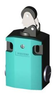
SIRIUS POSITION SWITCH METAL ENCLOSURE 56MM WIDE DEVICE CONNECTION 3X (M20X1.5) 1NO/1NC SLOW-ACTION CONTACTS METAL ROLLER LEVER AND PLASTIC ROLLER 22MM
