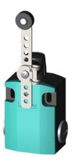
SIRIUS POSITION SWITCH METAL ENCLOSURE 56MM WIDE DEVICE CONNECTION 3X (M20X1.5) 1NO/ 1NC SLOW-ACTION CONTACTS ROTARY ACTUATOR RIGHT/LEFT ADJUSTABLE, W. LENGTH ADJUSTABLE METAL LEVER 100MM LONG AND W. POSITIVE FIT (HOLE PITCH), AND PLASTIC ROLLER 19MM
