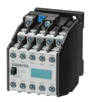
CONTACTOR RELAY 82E EN 50 011 8NO+2NC, SCREW TERMINALS AC OPERATION AC 230/220V 50HZ, 276/264V 60HZ
