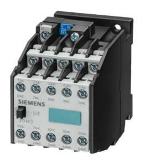
CONTACTOR RELAY 73E EN 50 011 7NO+3NC, SCREW TERMINALS AC OPERATION AC 230/220V 50HZ, 276/264V 60HZ
