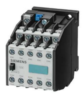
CONTACTOR RELAY 64E EN 50 011 6NO+4NC, SCREW TERMINALS AC OPERATION AC 230/220V 50HZ, 276/264V 60HZ
