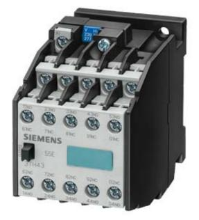
CONTACTOR RELAY 55E EN 50 011 5NO+5NC, SCREW TERMINALS AC OPERATION AC 230/220V 50HZ, 276/264V 60HZ
