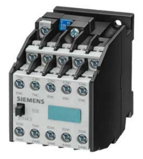
CONTACTOR RELAY 53E EN 50 011 5NO+3NC, SCREW TERMINALS AC OPERATION AC 230/220V 50HZ, 276/264V 60HZ
