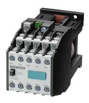
CONTACTOR RELAY 53E EN 50 011 5NO+3NC, SCREW TERMINALS DC OPERATION DC SOLENOID SYSTEM DC 24V
