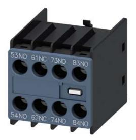
AUX.SWITCH BLOCK,FRONT,3NO+1NC, CURR.PATH: 1NO, 1NC, 1NO, 1NO, FOR CONTACTOR RELAYS, SZ S00, SCREW TERMINAL 53 / 54,61 / 62,73 / 74,83 / 84
